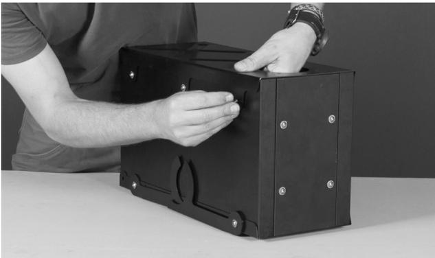
Montez le conduit d'aération sur le couvercle et sur la paroi latérale (3x boulons).
