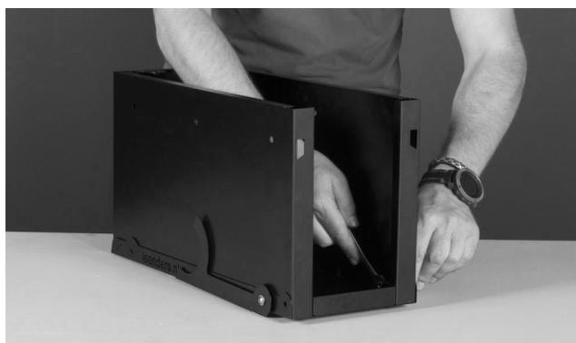
Montez les pieds de façade<sup>6</sup> (2x boulons + 2x écrous de verrouillage).
