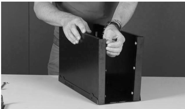
Montez la paroi arrière<sup>4</sup>. Commencez par visser les boulons (6x) dans les parois latérales. Ne pas serrer. Ceci fait, faites y coulisser la paroi arrière et visser les boulons (6x) à fond.
