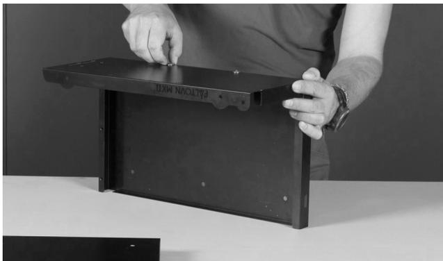
Montez la tôle de fond<sup>1</sup> sur la plaque latérale<sup>2</sup> gauche (2x boulons dans le fond).
