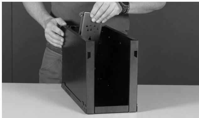
Montez le réservoir d'air<sup>5</sup> (en forme de tipi) sur la paroi arrière (4x boulons).
