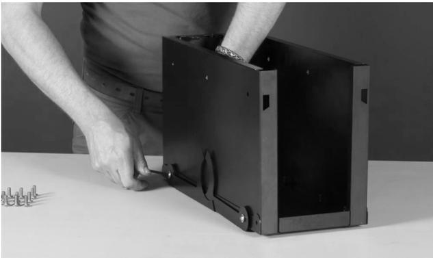
Montez les pieds arrière<sup>7</sup> (2x rondelles d'épaisseur + 2x boulons + 2x écrous de verrouillage).
