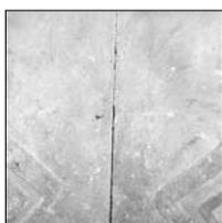
De légères fissures peuvent se constituer dans la pierre, ceci s'avère tout à fait normal et ne pose aucun souci quant au bon fonctionnement de l'appareil. Seul en cas de fissure à travers la pierre et donc une exposition à la chaleur de l'arrière de l'appareil en acier nécessiterai aussitôt le remplacement de la ou les pierres.
