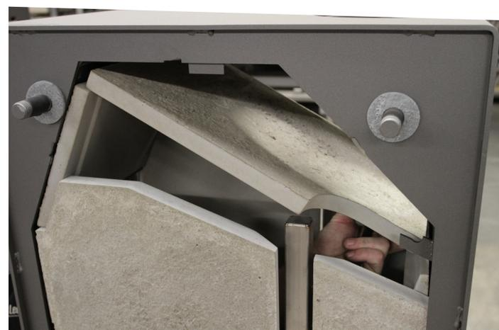
Ou, déposer la tige métallique soutenant le déflecteur supérieur et le basculer vers l'arrière afin que les suies tombent dans le Boxer Plus. Uniquement pour le modèle avec tige.
