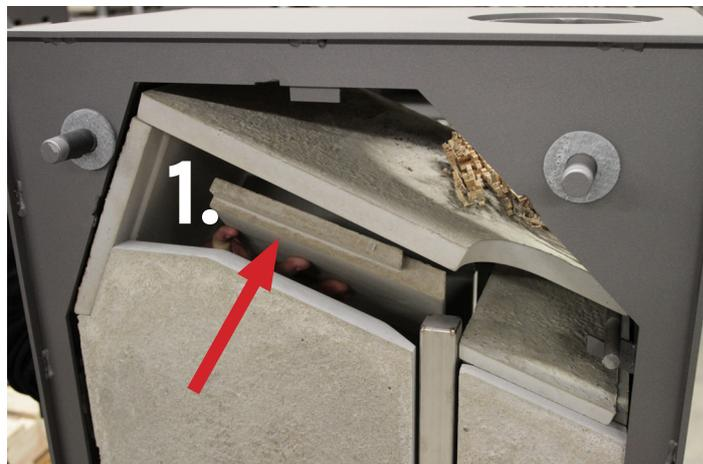
Déposer les deux déflecteurs (1. et 2.) en les soulevant et en les inclinant.
